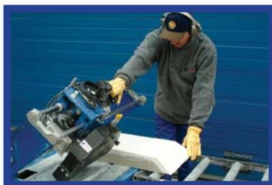
Des banquettes peut être scier avec un scie a disque diamant.
