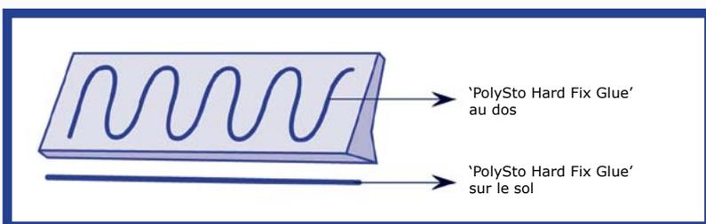
Appliquer à l'aide du pistolet à silicones une ligne de 'PolySto Hard Fix Glue' sur le sol et au dos de la banquette.
