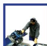
tafelzaagmachine met zaagblad
